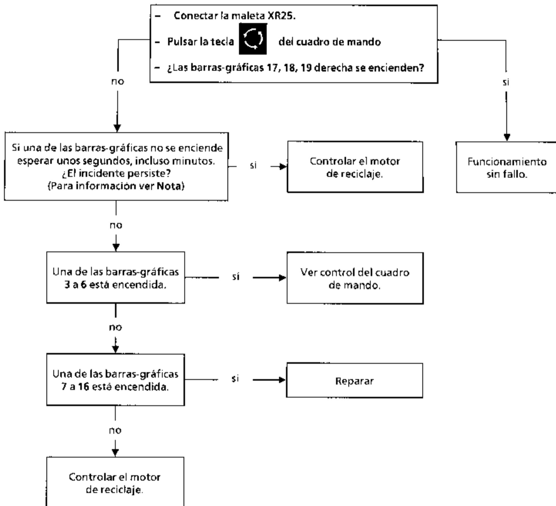
**Nota :** tras el arranque del sistema de regulación de temperatura por ambiente frío, el calculador del sistema puede bloquear la información de reciclaje durante unos segundos. Sólo la barra-gráfica 17 está encendida. Además para diferencias "temperatura exterior/nivel de confort seleccionado" muy importantes y en particular cuando la temperatura exterior es muy elevada, el sistema de regulación impone el reciclaje automático. Las barras-gráficas 18 y 19 se encienden a derecha.
