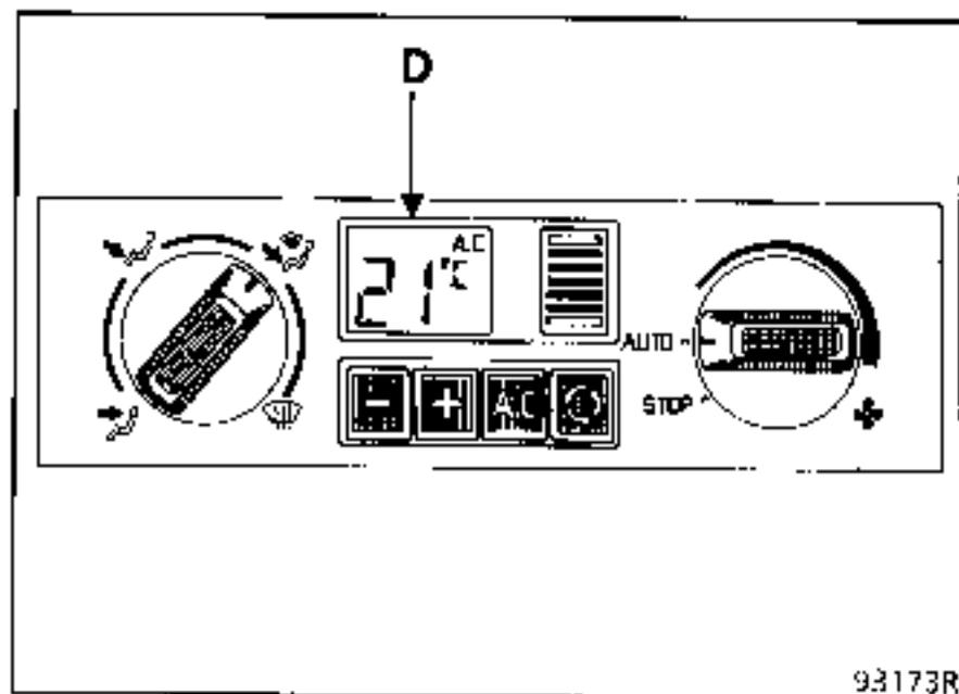
Presionar la tecla "A-C" (E) para poner en servicio el aire acondicionado, el grafismo "A-C" aparece en la pantalla (D). El aire fresco es tomado del exterior del vehículo y renovado constantemente.
