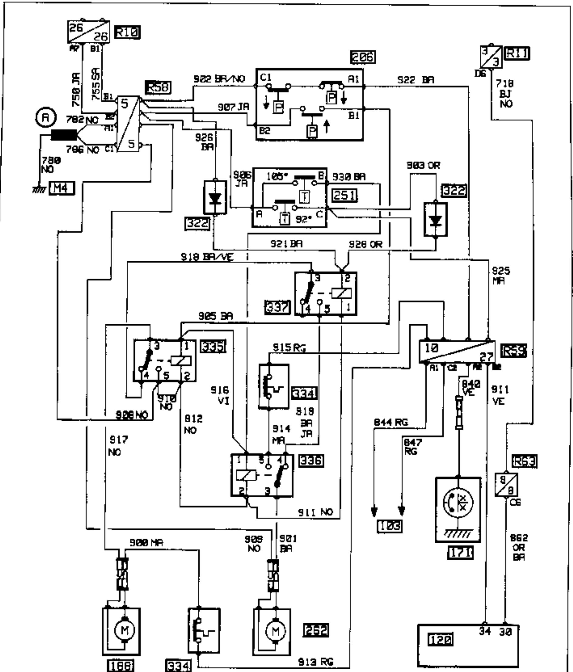
ESQUEMA DE CABLEADO - Lado motor longitudinal (gasolina) - Modelo 1990
