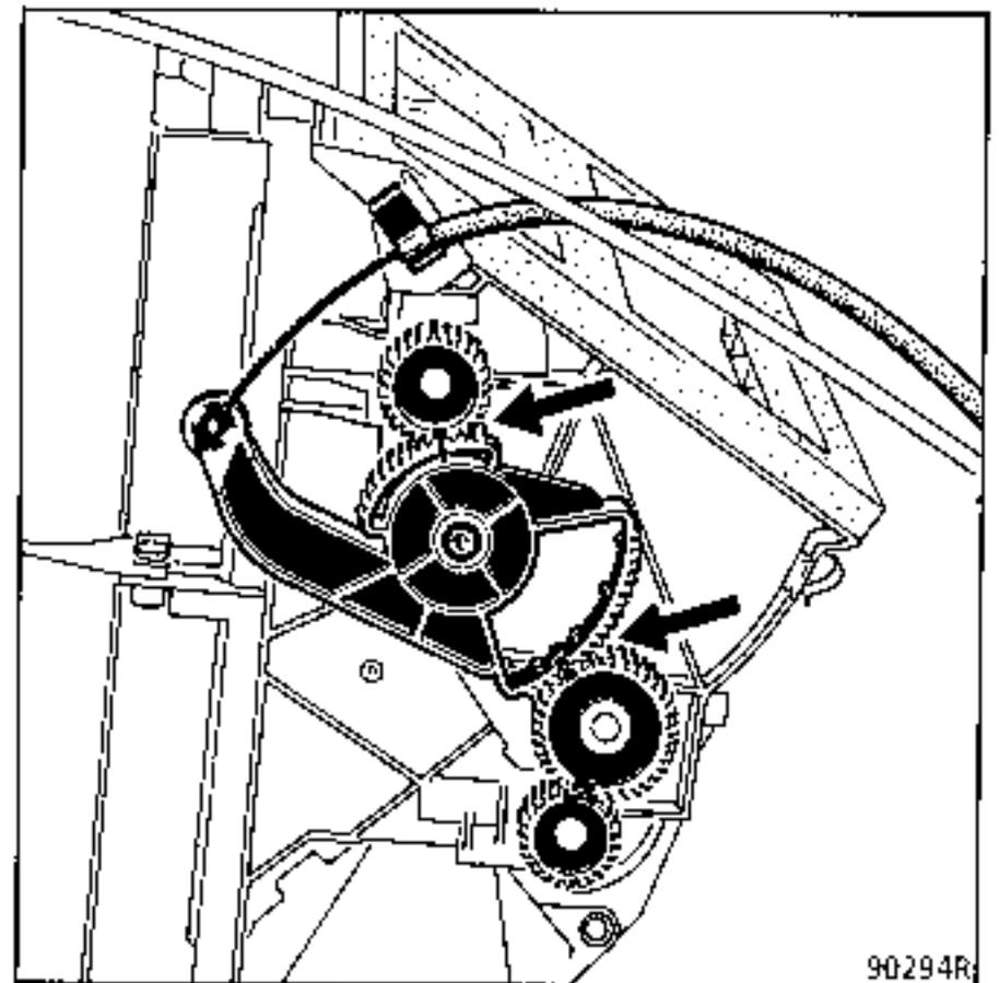
Si el reglaje es imposible en el conjunto de mando de los cursores, proceder de la misma manera haciendo el reglaje en el lado del sistema de soplado.
