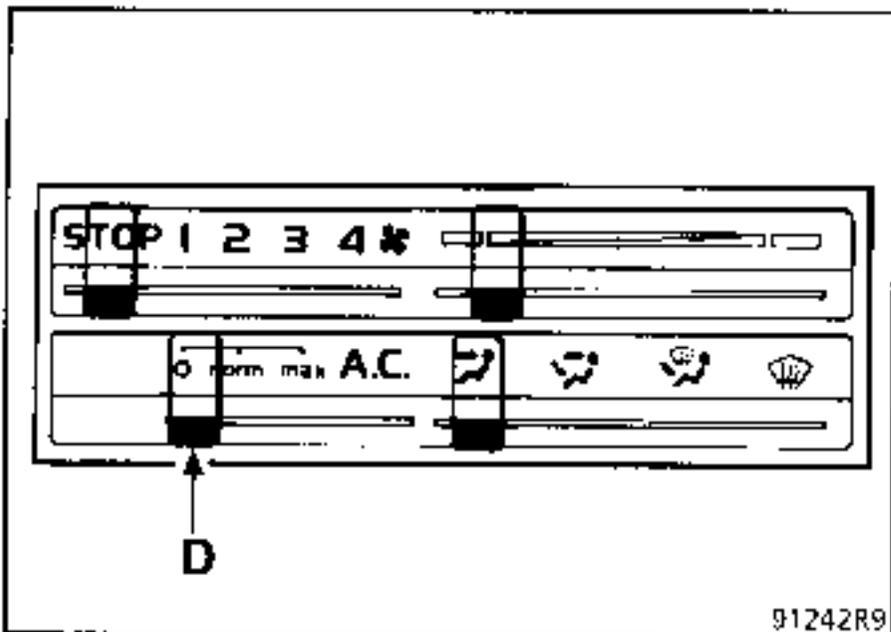
**POSICION 0 :** el aire acondicionado no está en funcionamiento, la climatización tiene las mismas funciones que un vehículo desprovisto de aire acondicionado.
