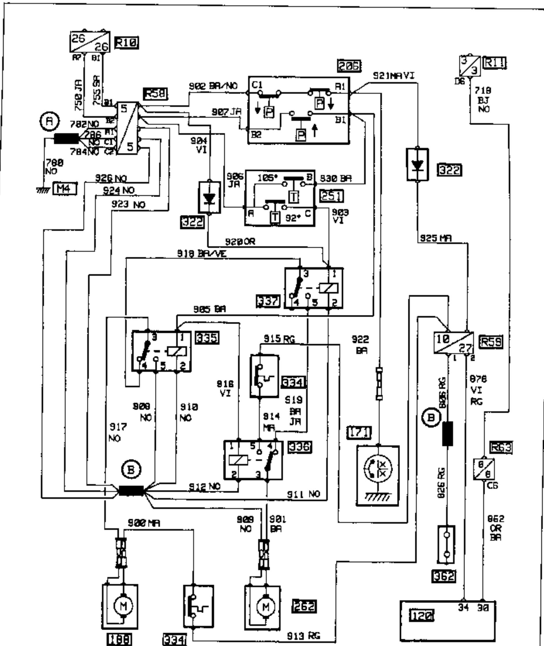
ESQUEMA DE CABLEADO - Lado motor longitudinal (diesel) - Modelo 1990
