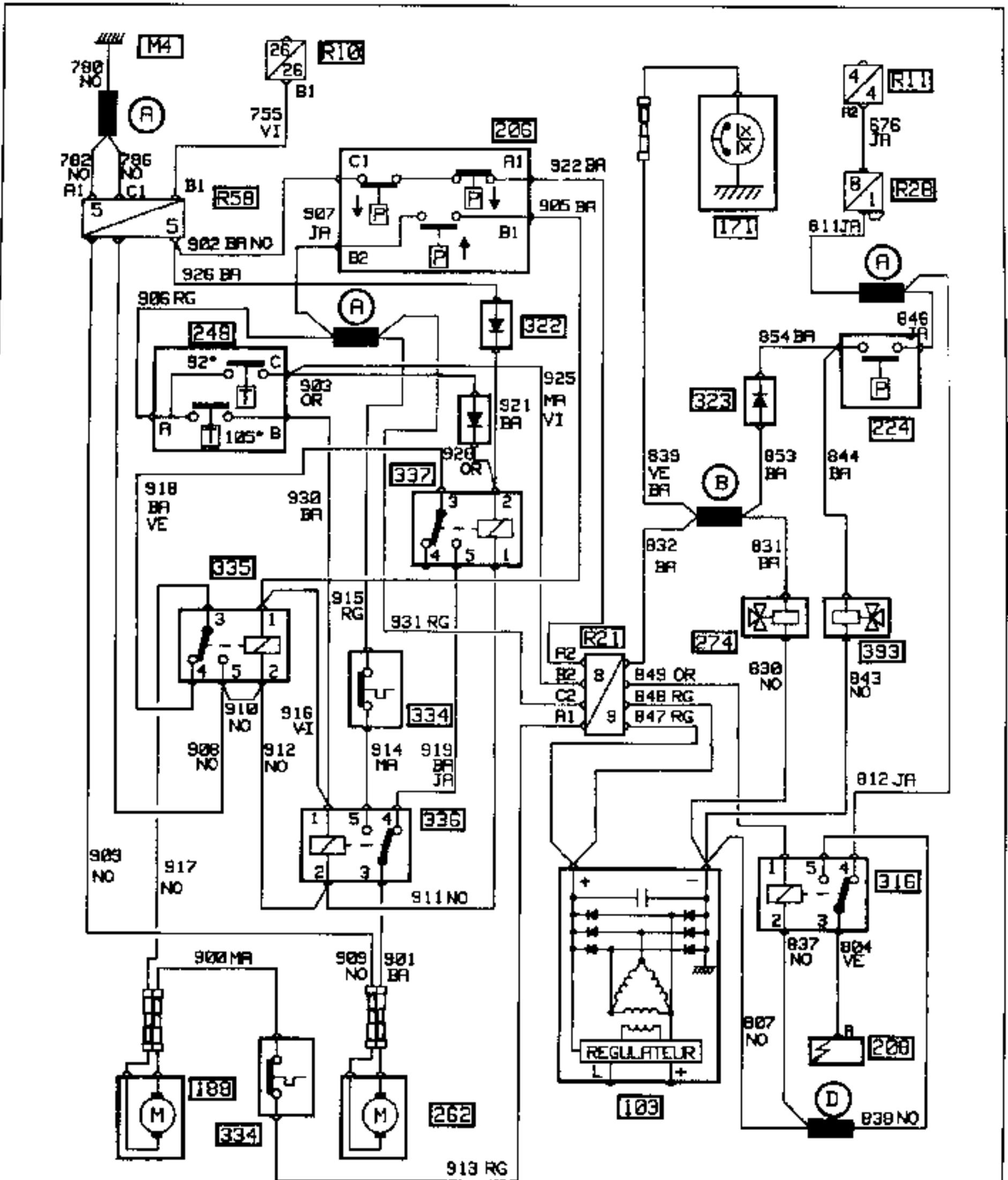
ESQUEMA DE CABLEADO - Lado motor - F3N - Modelo 1990
