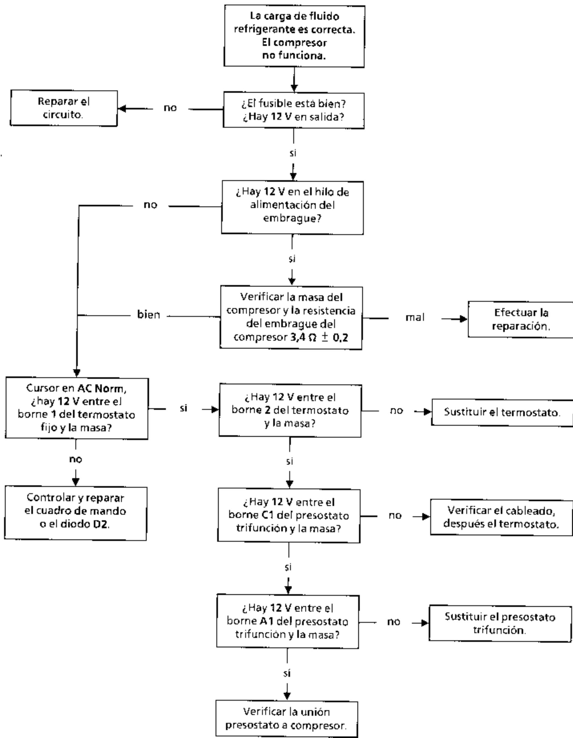
NOTA : El control de aire acondicionado no puede efectuarse más que si la temperatura es superior a + 4 °C.
