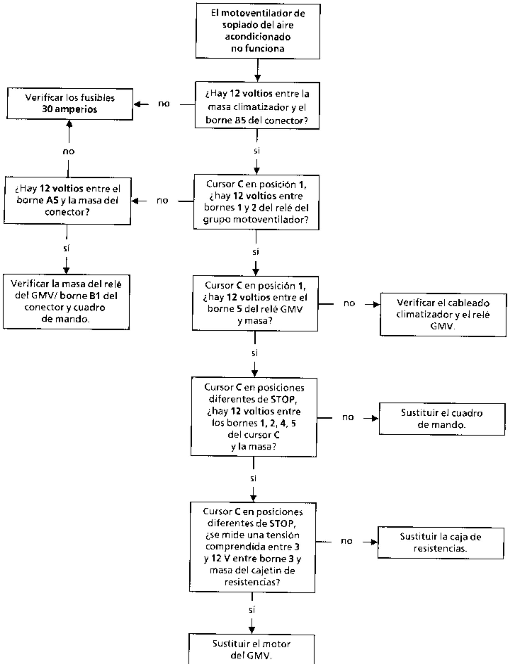
**Nota :** tensión de funcionamiento del motoventilador medida entre los bornes 87 del relé del GMV y A5 ó B5 del conector (6), posición :
