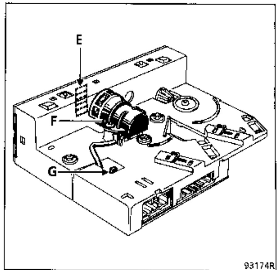
Termistancia de coeficiente de temperatura negativa integrada en el cuadro de mando con sistema de ventilación de la sonda (F). Todo fallo de la sonda exige cambiar el cuadro de mando.
