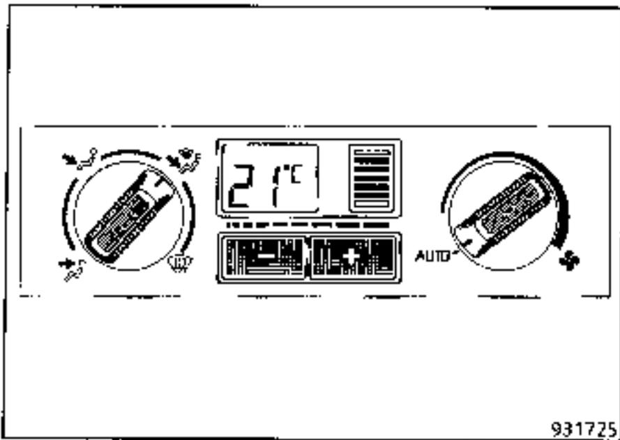
Las dos teclas "-/+ " permiten el reglaje del nivel de confort (temperatura media medida a la altura de las cabezas delanteras) de 18 °C a 28 °C.
