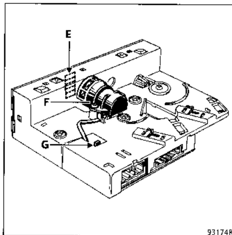
Anomalia : BARRA-GRAFICA 14 IZQUIERDA O DERECHA ENCENDIDA : (Motor de la trampilla de mezcla)
