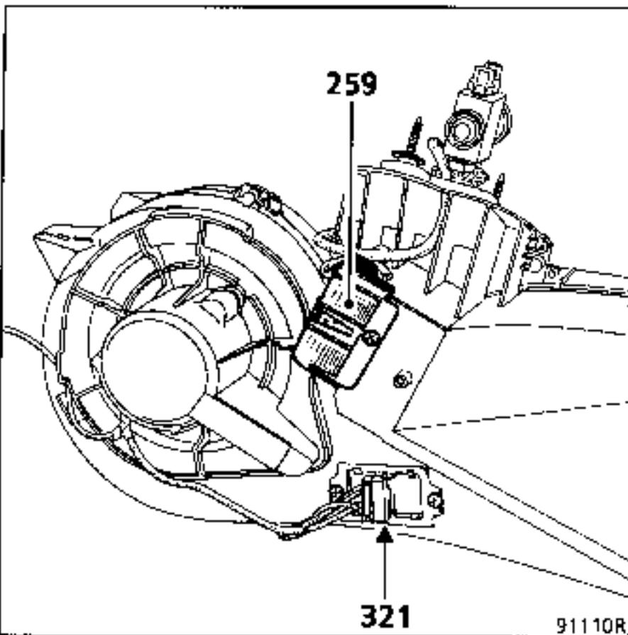
Extraer la pantalla anti-ruido del motor, bajo el tablero de bordo.
