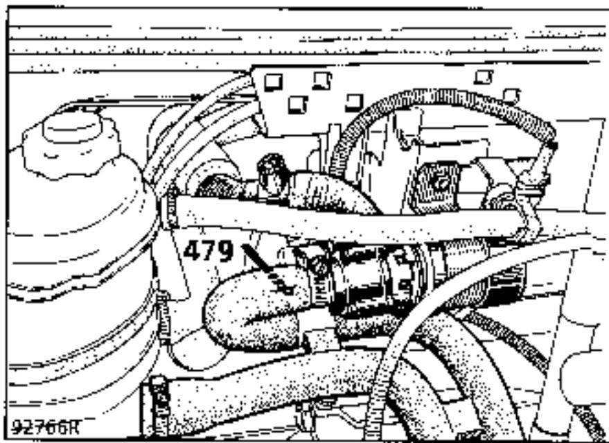
Esquema de cableado de la bomba de circulación del agua de calefacción X48
