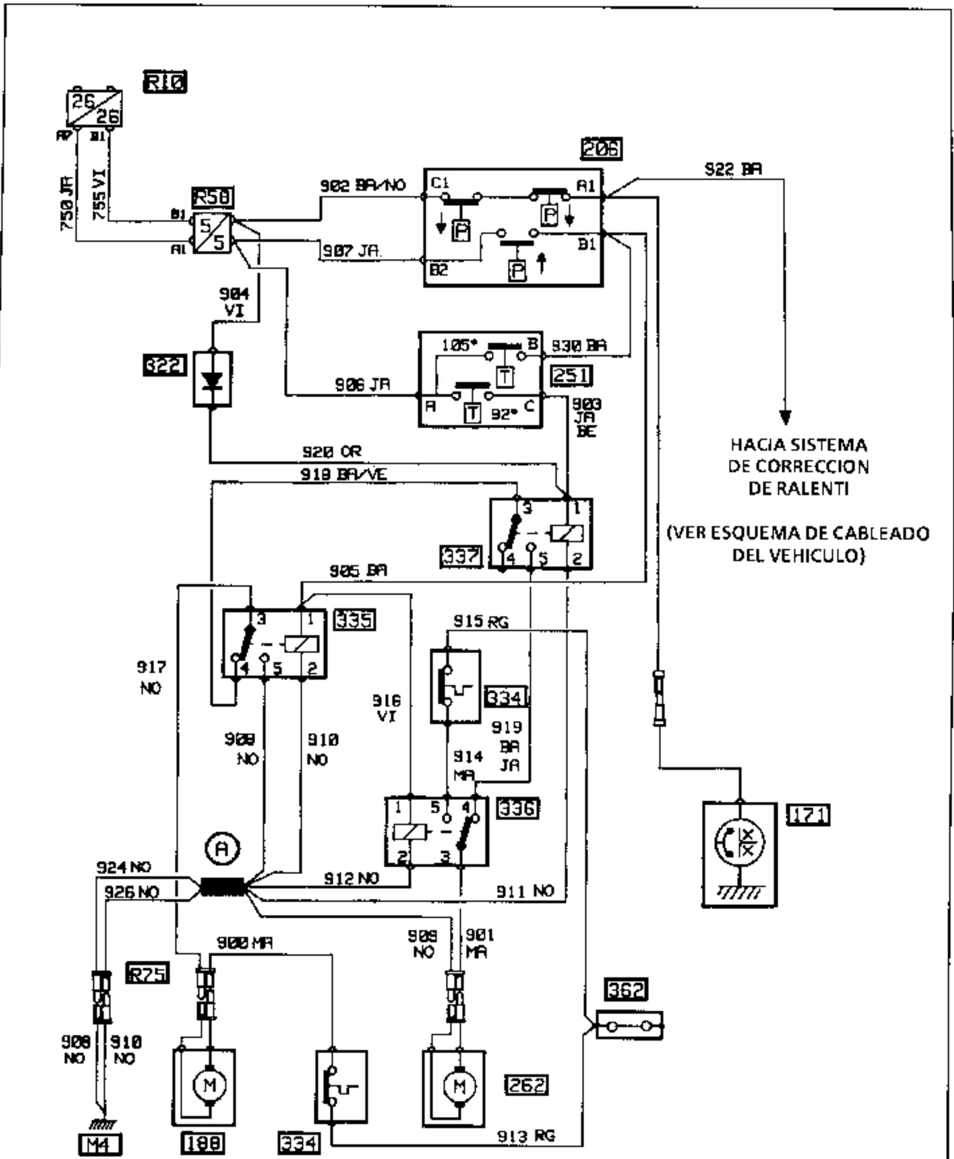
ESQUEMA DE CABLEADO - Lado motor - F2N - Modelo 1990
