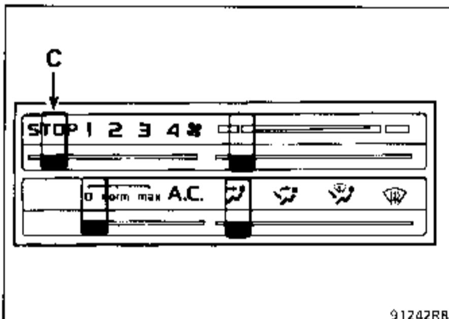
**POSICION 4 :** posición que da el máximo de eficacia a la ventilación de la instalación.
