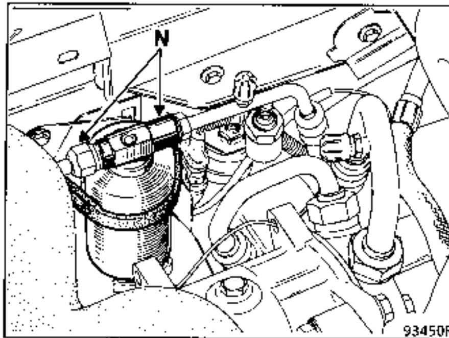
En el montaje, aceitar las roscas con aceite para compresor y vigilar el buen estado de las juntas.
