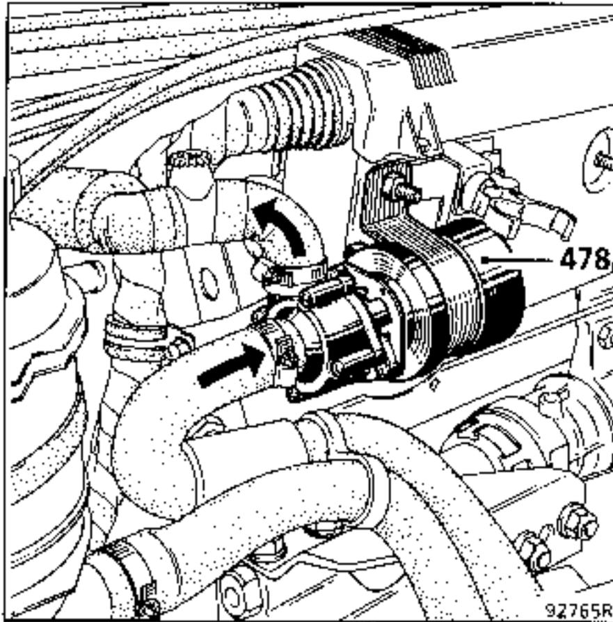
Esta bomba está colocada en el salpicadero del compartimento motor, en serie con el circuito de agua.
