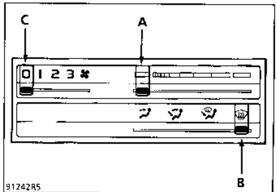
El flujo de aire está dirigido hacia el aireador del parabrisas (b) y los aireadores del tablero de bordo (c).
