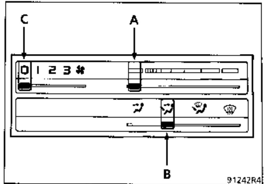
El flujo de aire se reparte entre los aireadores del tablero de bordo (c) y los aireadores inferiores (d) y (e). Cuando el aire ha sido calentado mediante el cursor (A), la temperatura del aire de los aireadores del tablero de bordo (c) es inferior a la de los aireadores (d) y (e).
