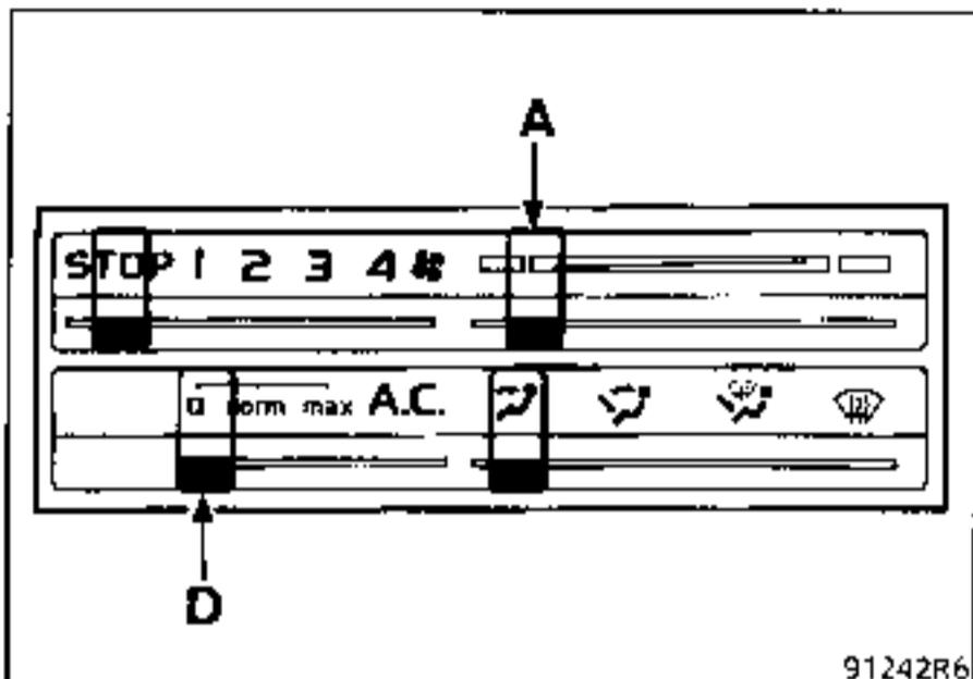
Cuando el mando del aire acondicionado (D) esté en posición "AC Norm" o "AC Max", el aire es inicialmente enfriado y desecado al atravesar el evaporador, después, una parte mas o menos importante es recalentada al atravesar el radiador.
