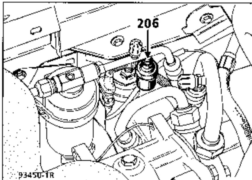
Toda intervención en el presostato puede hacerse sin tener que vaciar el circuito de fluido refrigerante, está fijado sobre una válvula SKRADER.
