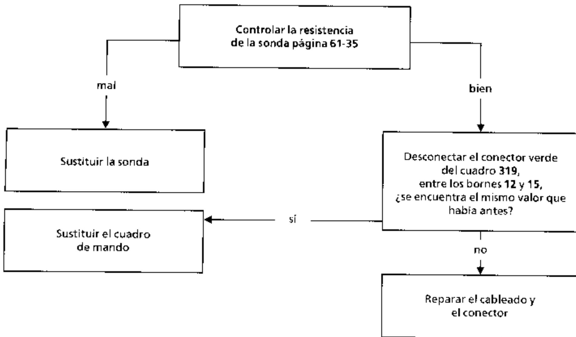
Anomalia : BARRA-GRAFICA 11 A DERECHA ENCENDIDA : (Potenciómetro trampa de mezcla)
