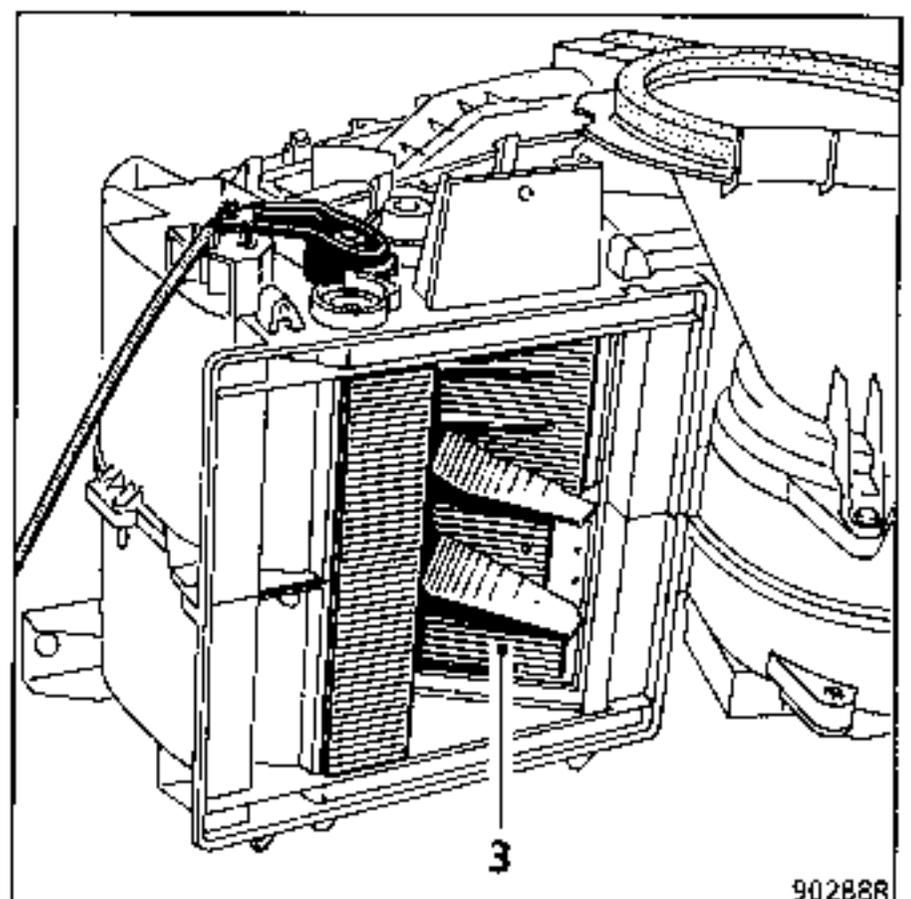
El dispositivo de soplado no contiene grifo de calefacción y es alimentado de forma permanente. La trampilla (3) asegura el funcionamiento del sistema de recalentamiento del aire fresco.
