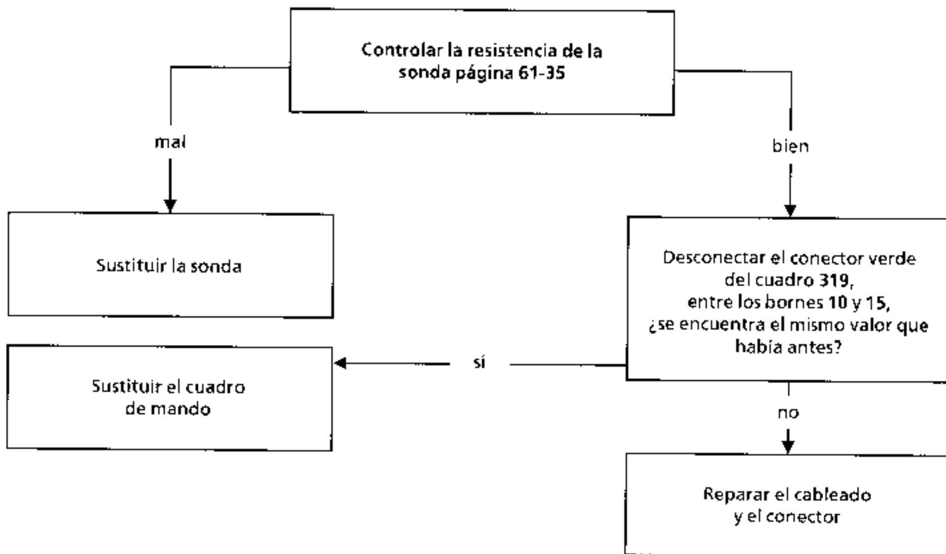
Anomalia : BARRA-GRAFICA 10 ENCENDIDA : (Temperatura aire soplado)
