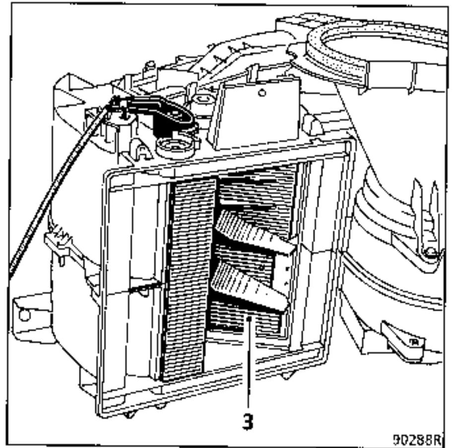
El dispositivo de soplado no posee grifo de calefacción y está alimentado permanentemente. La trampilla (3) asegura el funcionamiento del sistema de calentamiento del aire fresco.
