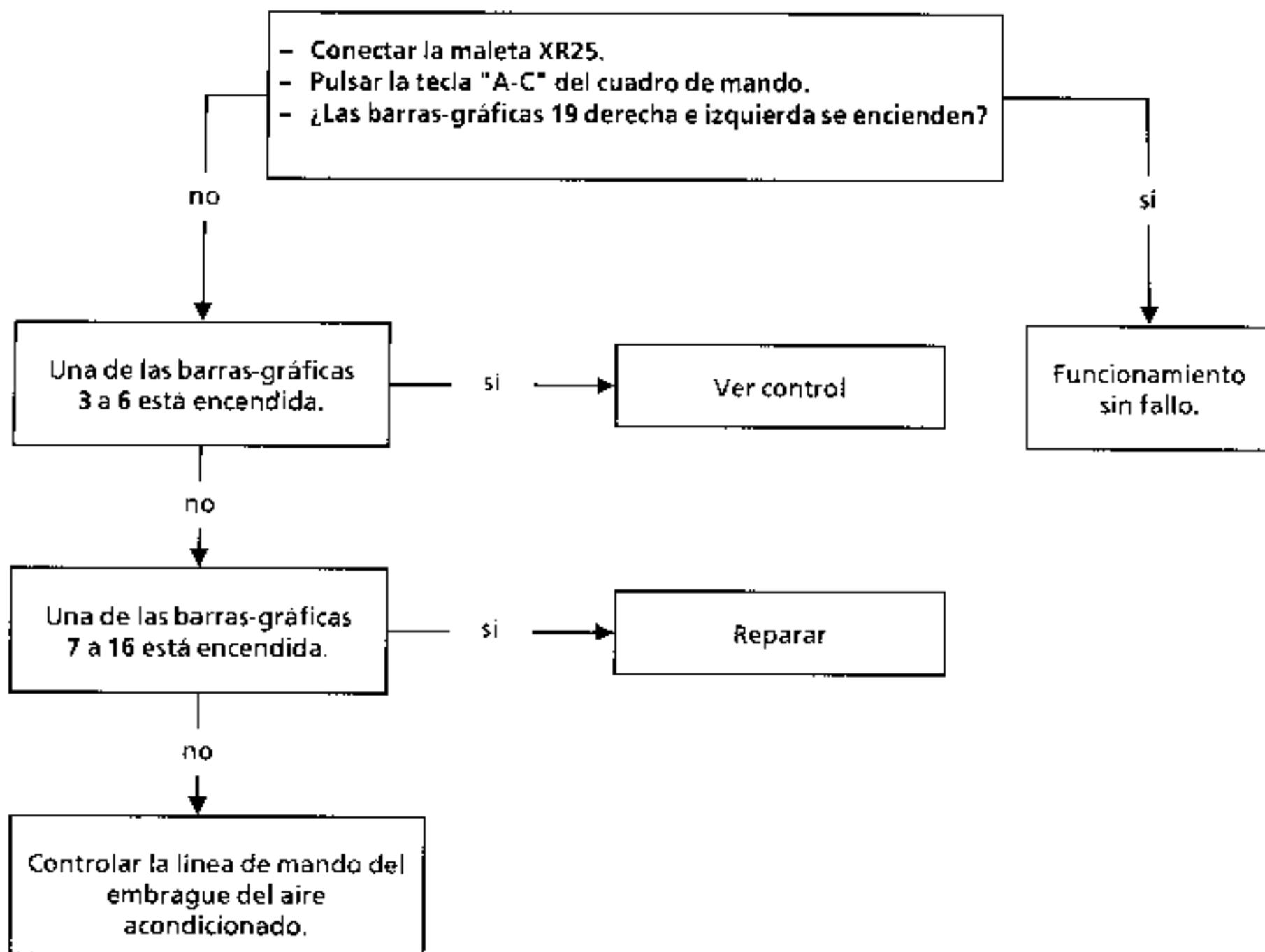
Control de las sondas de temperaturas interiores, exteriores y aire soplado.
