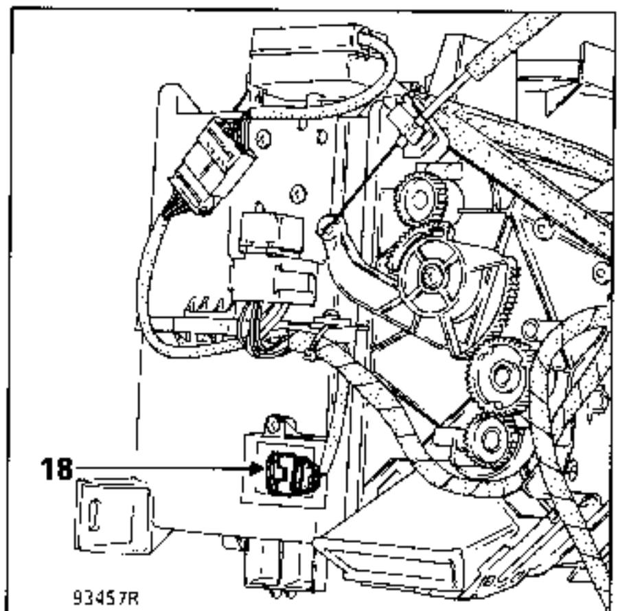
**Control sonda de temperaturas evaporador (408)**
